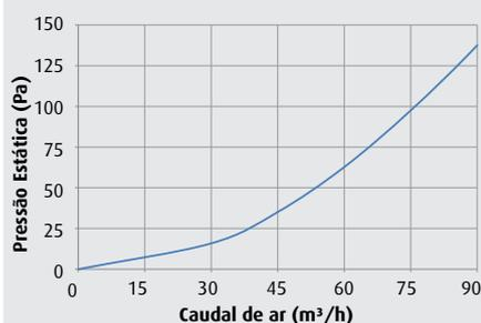
Diagrama terminal de parede externo Ø125
