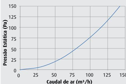
Diagrama terminal de parede externo Ø150
